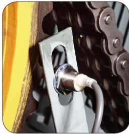
速度监控装置 Speed detector
